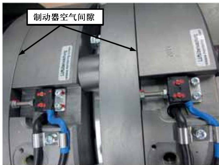
图2-15bSM250.60B和ZPML-K268型曳引机的制动器
