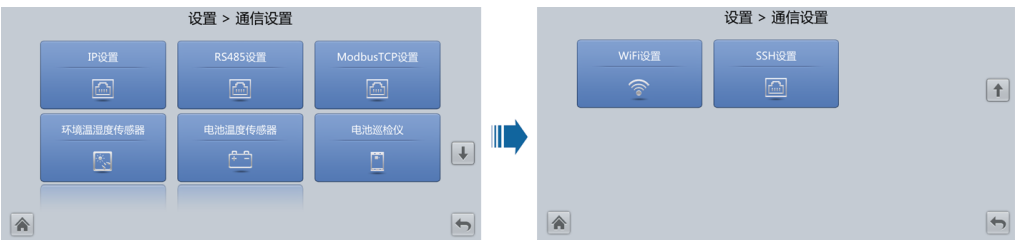
图 4-11 通信设置（铅酸电池）
