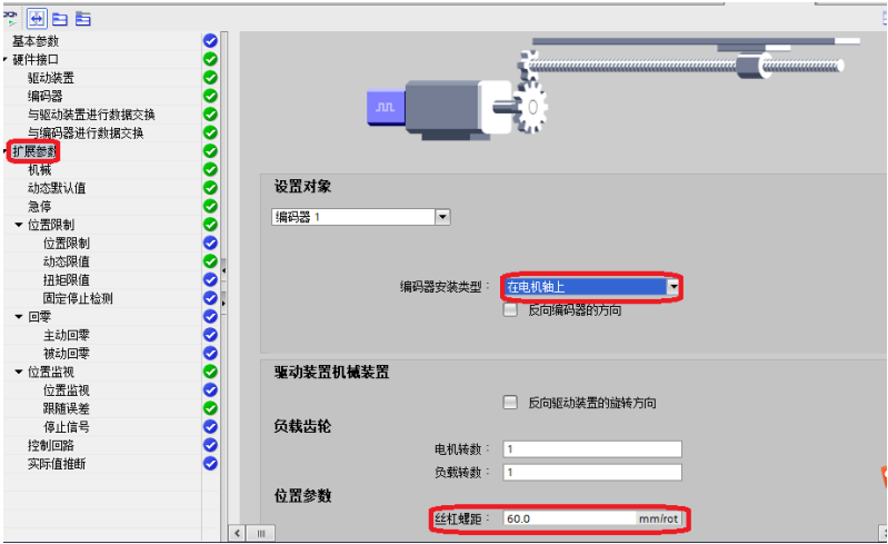
图7-98 设置编码器安装类型
