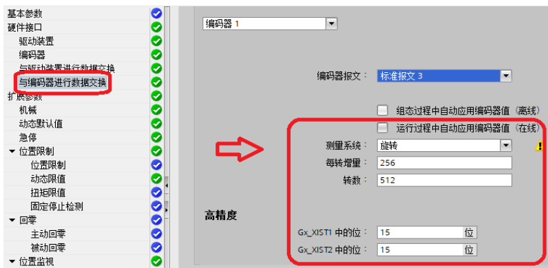
图7-97 绝对位置线性模式下编码器配置
