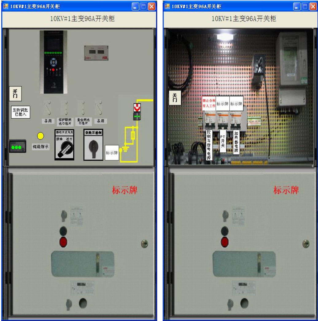
图 2-77 主变开关柜小车操作
