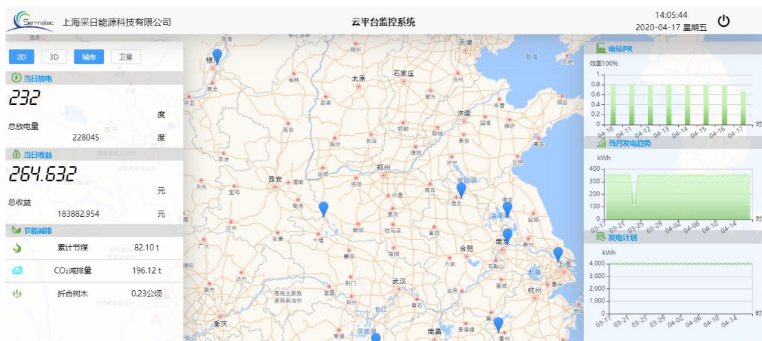
图 4: 左侧可切换 2D、3D、城市、卫星等视图, 当前放电量, 当日收益, 节能减排的详细数值; 右侧为电站 PR、当月发电趋势、发电计划等数据统计图。中间为设备安装地点显示图, 可在地图上显示已经安装的设备;
