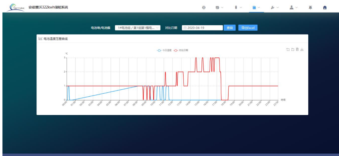
图 26: 电池温度差折现统计图, 可根据时间查看历史数据, 导出 Excel 表格;
