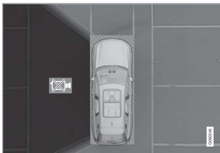
车辆左侧摄像头发生故障。
