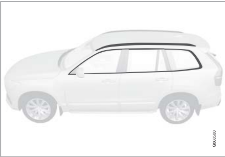
应使用 pH 值在 3.5 和 11.5 之间的清洁剂清洗零件。
