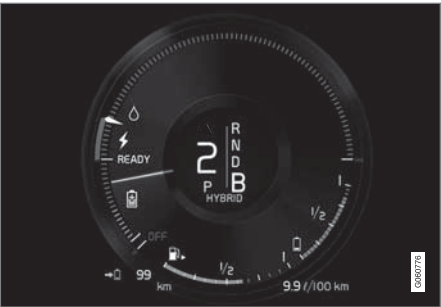
驾驶员显示屏指示在电动马达制动期间充电。
