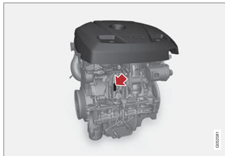
刻印的发动机号码位置，4 缸发动机（2.0 升）
