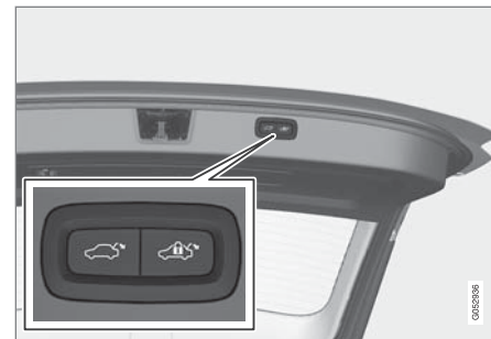
尾门底部用于关闭并锁止的按钮。
