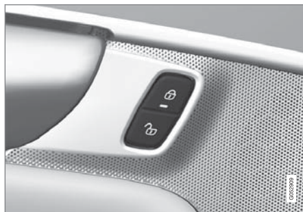
前车门处带指示灯的锁止按钮。
