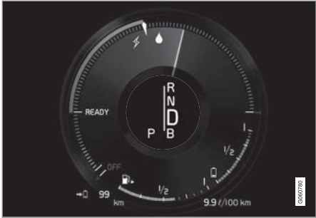
电动马达无法提供请求的发动机功率量，内燃发动机启动。
