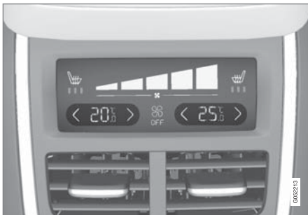
中央扶手控制台后部空调面板上的温度控制器。
