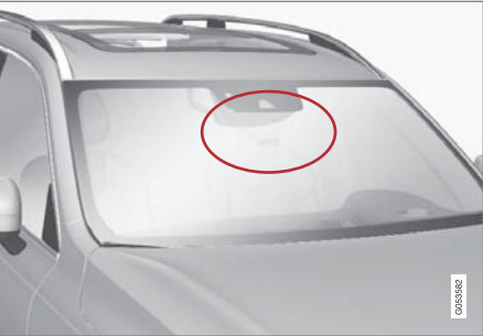
标出的区域必须无贴纸、物品、遮阳膜等 11 。
