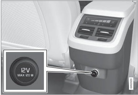
中央扶手控制台中的 12 伏电源插座，第二排座椅。
