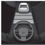
摄像头和雷达单元测量与前车的距离并探测两侧标线 8 。
