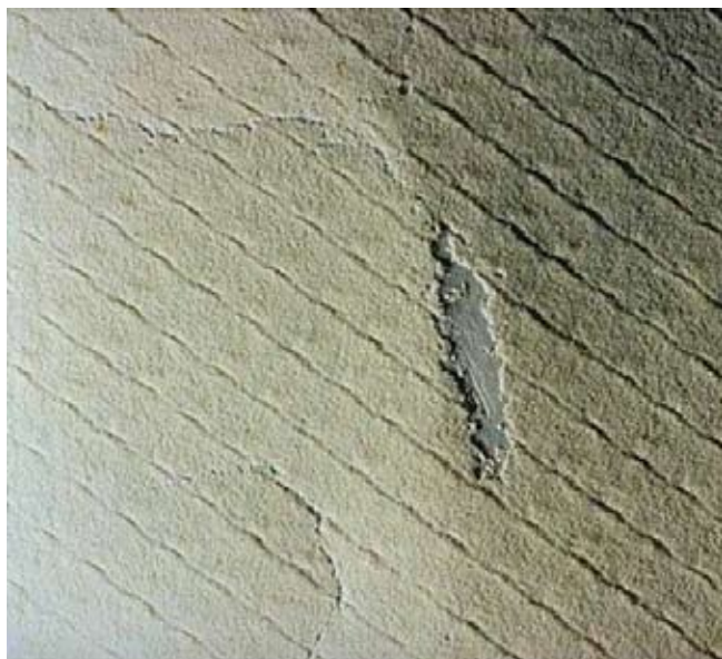
图 9-6 已经结垢的膜表面（进水流动网格在垢类上形成的压痕清晰可见）
