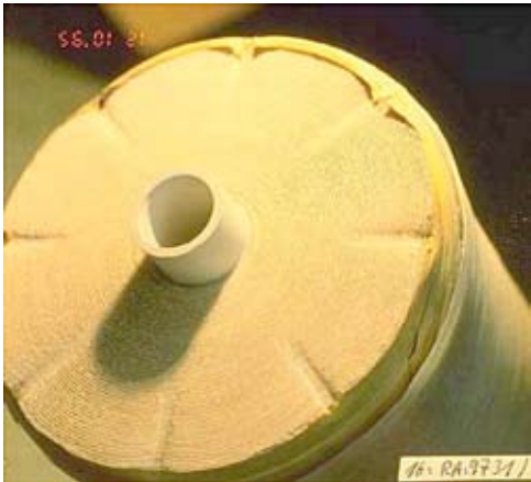
图 9-8 膜元件上抗应力器被拉掉了
