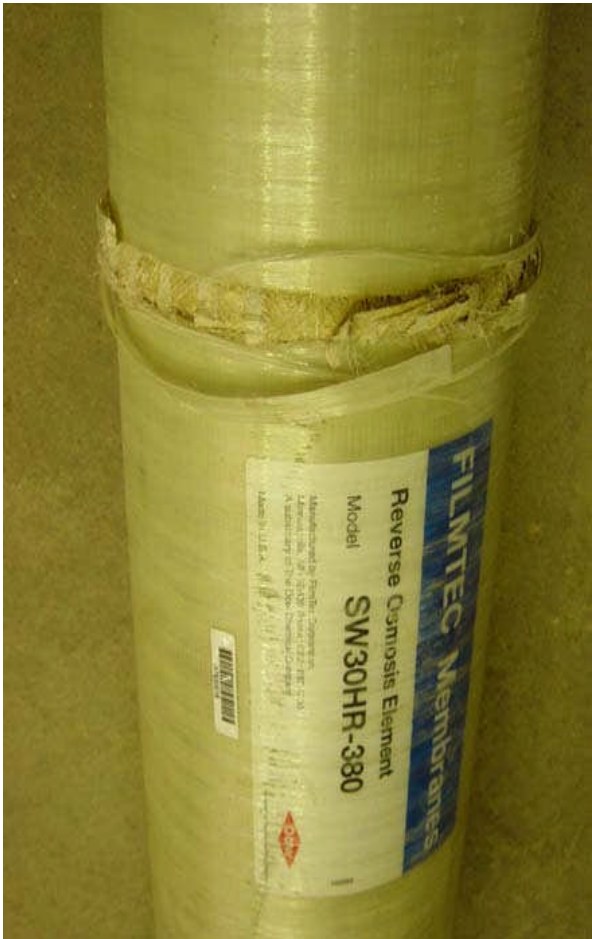
9-9 膜表面缠绕玻璃钢高压差破裂
