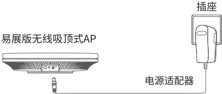
图2-2 DC供电示意图示
