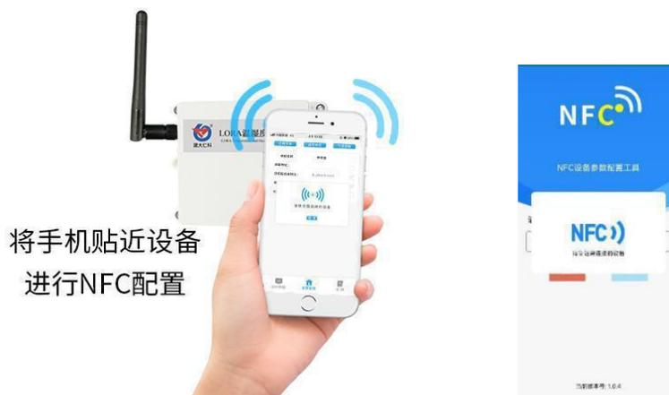
显示读取成功后，即可拿开手机，在输入框中输入密码（默认密码：12345678），然后点击确认。（下图 1）
