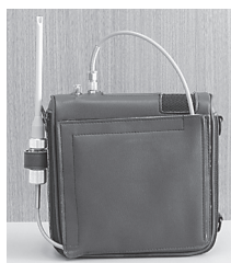
气体导入管放入包内， 可将排放过滤器固定于 侧面使用。
