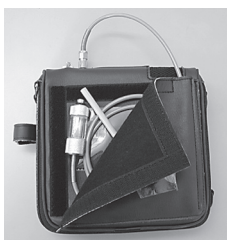
气体导入管和吸引管 可放在背面的口袋中
