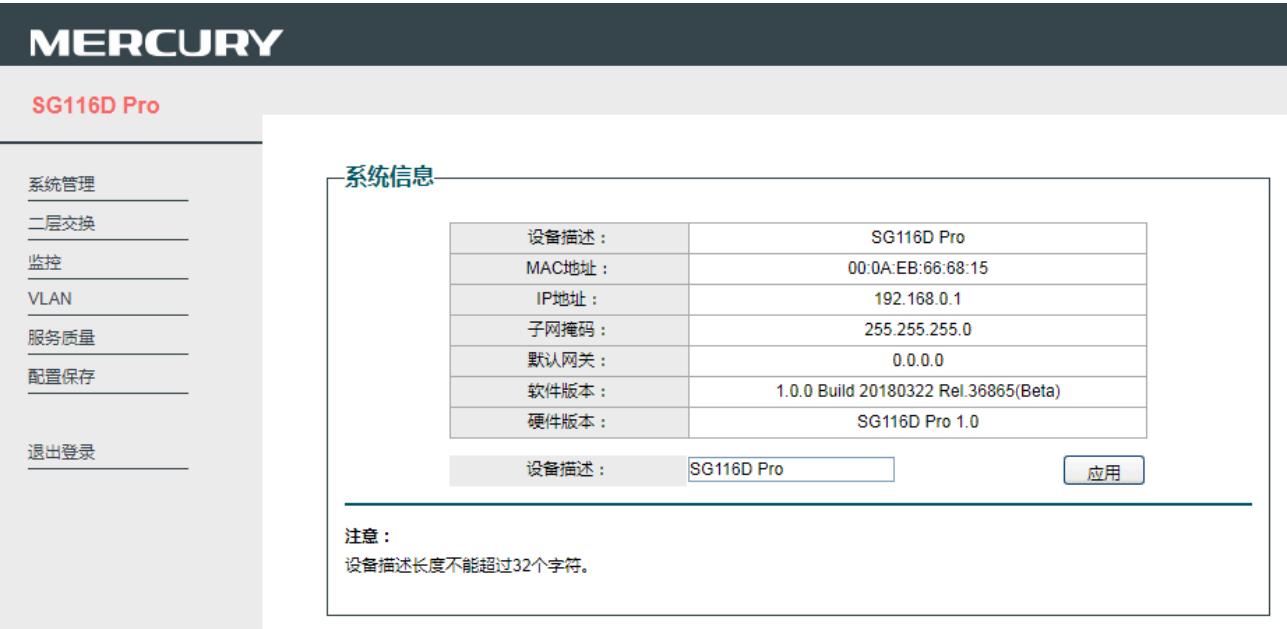
图 2-2 交换机首页界面
