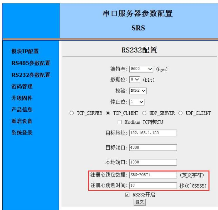
图 5.2.3 TCP\_CLIENT 模式注册心跳包设置
