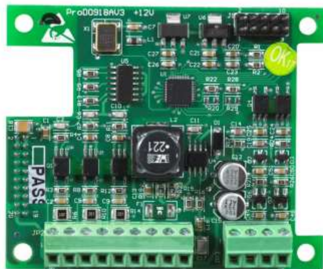
图 4-27 ABZ 增量型 PG 卡端子排列
