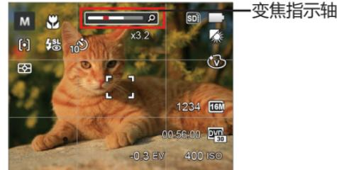
当光学变焦达到与数码变焦的临界点时，松开并再次按变焦按钮T端，就会自动完成光学和数码变焦的切换。
