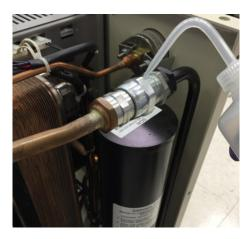
Figure 17 Leak Check Aeroquip Couplings
