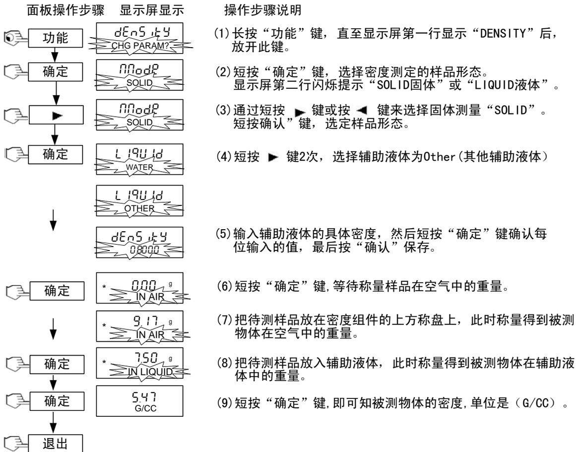
● 测量液体密度使用方法，操作步骤如下：
