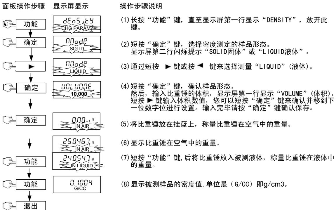
● 测量多孔材料密度使用方法，操作步骤如下：
