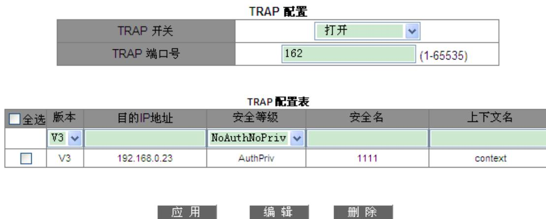
图 147 SNMP v3 Trap 配置
