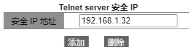
图 70 Telnet server 安全 IP 地址配置
