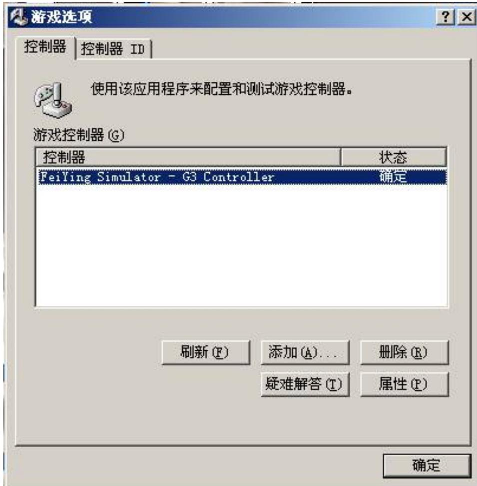
选择“属性”可以进行游戏控制器的测试和校准，校准是让系统记住每个操纵杆的中立位置，和每个操纵杆的最大行程。针对于软件RealFlight G3，在此处进行校准是没有意义的。在“测试”页，您可以对游戏控制器进行测试。
