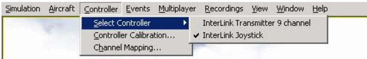
将飞鹰模拟器滑动开关拨到模式-3，进入G3程序。如上图所示，在Select Controller中有两个控制器可以选择，其中InterLink Transmitter 9 channel对应于接口PPM 1，而InterLink Joystick对应于接口PPM 2。此模式下可以同时连接两台遥控器，在RealFlight G3中进行双人游戏。
