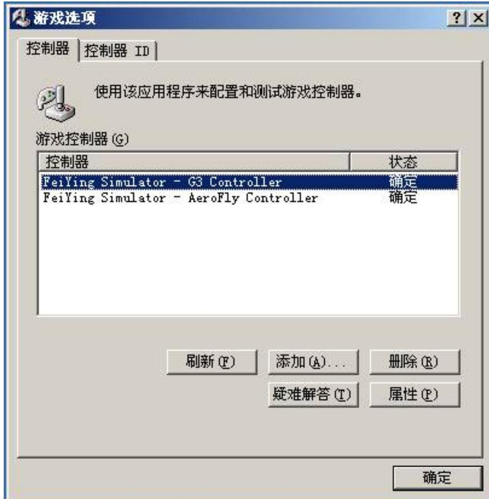
选择“属性”可以进行游戏控制器的测试和校准, 校准是让系统记住每个操纵杆的中立位置, 和每个操纵杆的最大行程。针对于软件AeroFly Professional Deluxe, 在此处进行校准是没有意义的。在“测试”页, 您可以对游戏控制器进行测试。
