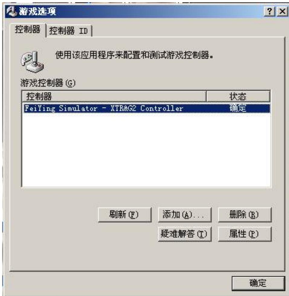
选择“属性”可以进行游戏控制器的测试和校准，校准是让系统记住每个操纵杆的中立位置，和每个操纵杆的最大行程。针对于软件Reflex XTR，在此处进行校准是没有意义的。在“测试”页，您可以对游戏控制器进行测试。
