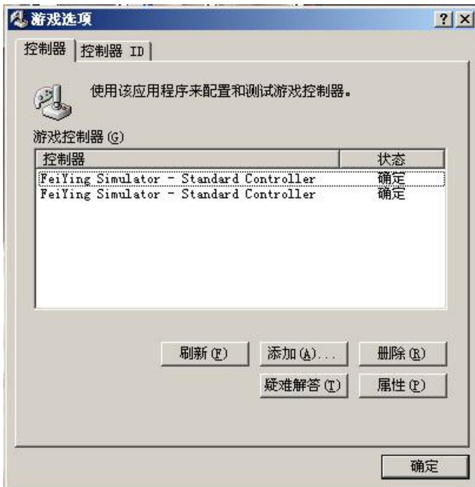
选择“属性”可以进行游戏控制器的测试和校准，校准是让系统记住每个操纵杆的中立位置，和每个操纵杆的最大行程。在“测试”页，您可以对游戏控制器进行测试。
