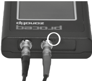
图 3: 与 4.0 MHz 传感器连接。 确保红色线缆连接到带红点的端口。
