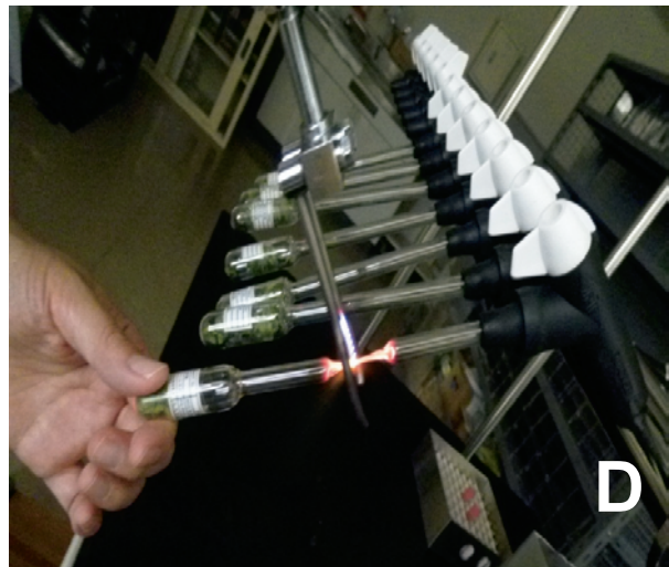
図 8. ジーンバンクでの真空乾燥保存アンプルの作製手順
