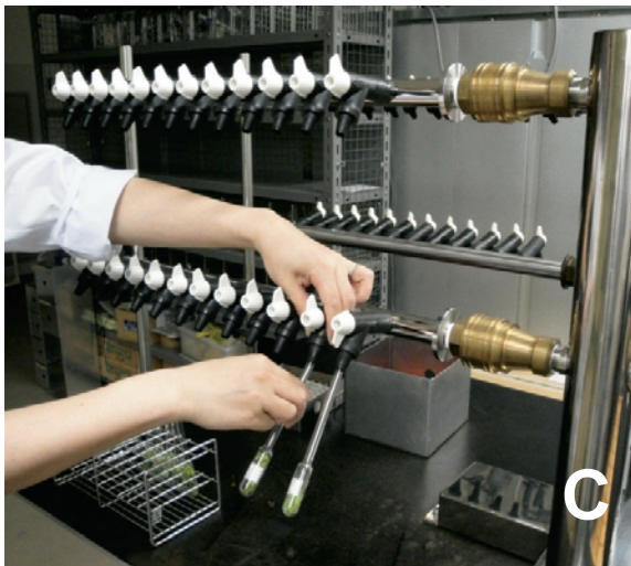
図 8. ジーンバンクでの真空乾燥保存アンプルの作製手順
