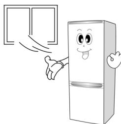
●冰箱顶部空间不少于30cm、两侧及背面与墙的距离不少于10cm，周围不能有障碍物，拆去包装后留出可使冰箱门打开120°以上角度的空间。
