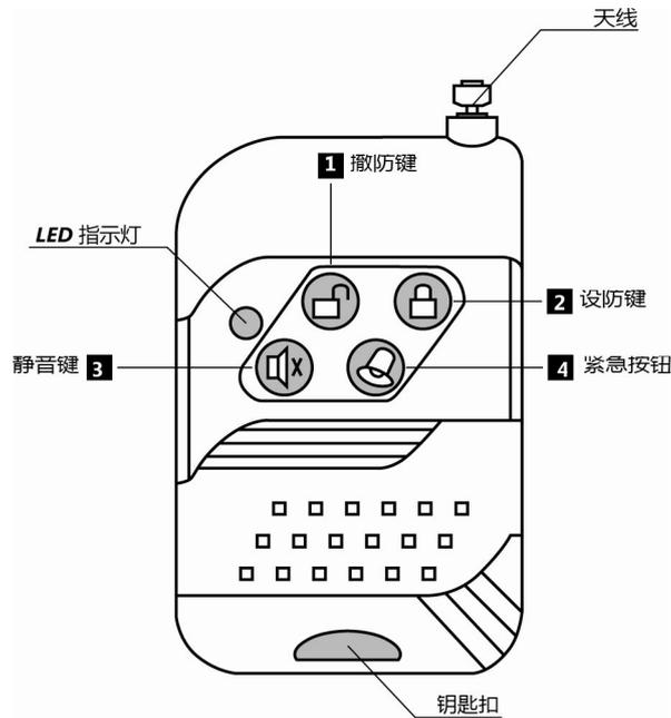
SR800E 无线遥控器示意图 (Remote Controller)
