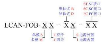
例如选型双纤单模 FC 接口、导轨式、电源外置的 CAN 总线式光纤调制解调器,则订购型 号为 LCAN-FOB-S2-D0-FC。
