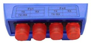
LCAN-FOB 具有两个或两对光纤接口,如果选择单纤传输,则是两个光纤接口;如果选择双纤传输,则是两对光纤接口。用户可以根据需要选择单光纤或双光纤传输光信号,当选用单纤时,光信号通过单纤传输,所以只需一个接口,接口标识为 TX/RX;当选用双纤时,光信号的收发接口分开,分别为 TX 和 RX。
