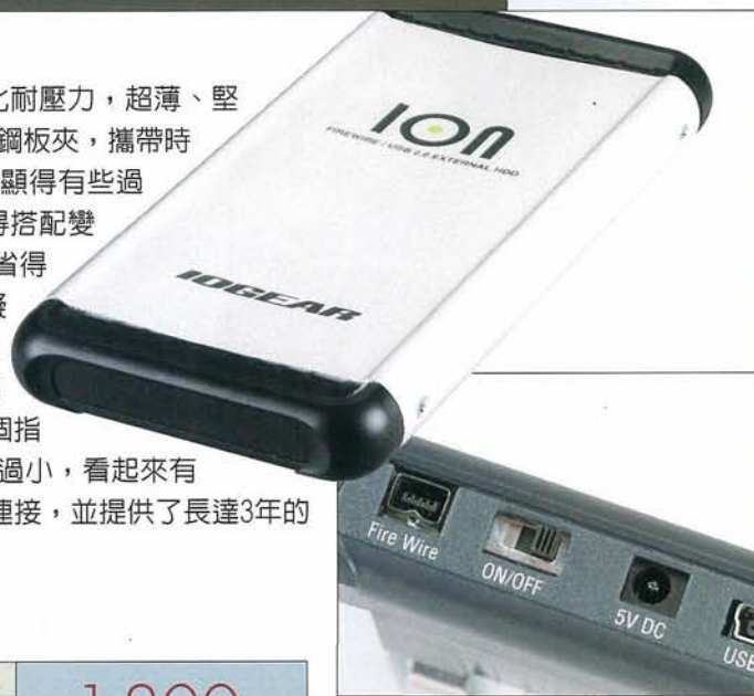
除了FireWire接頭外，機身上也少見地附有一個電源開關可切換。
