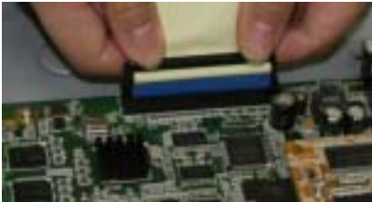
第三步：将硬盘数据线的蓝色插头接到主板的IDE接口上。
