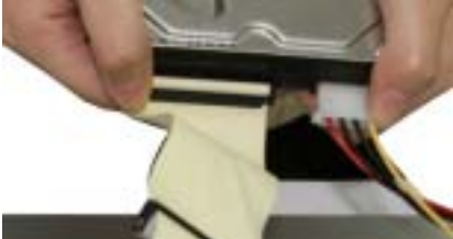
第四步：将硬盘电源线的另一端，及数据线的另一端（黑色插头）接到硬盘上
