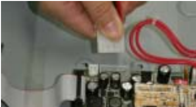
第二步：将硬盘电源线的一端接到主板的电源插座上。
