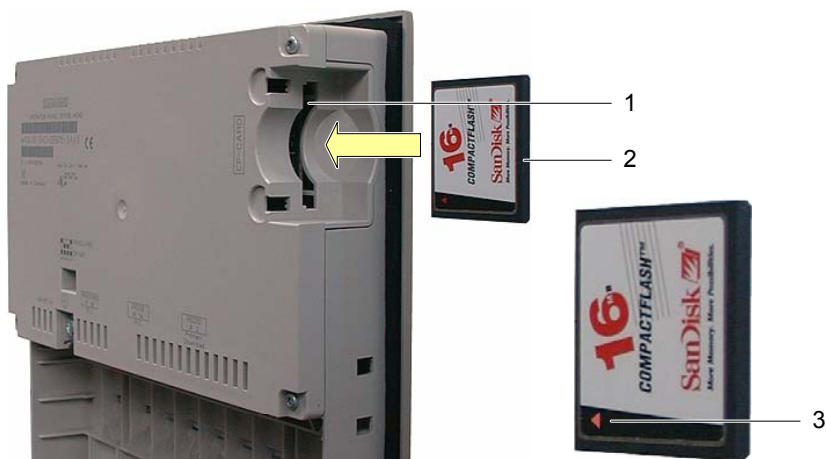
图索 5-4 将存储卡插入OP 170B
