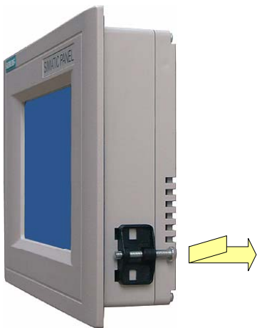
图例 4-1 在TP 170micro、TP 170A和TP 170B上插入弹簧端子
