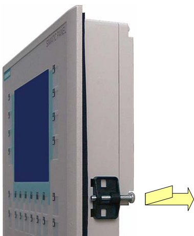
图例 4-2 在OP 170B上插入弹簧端子
