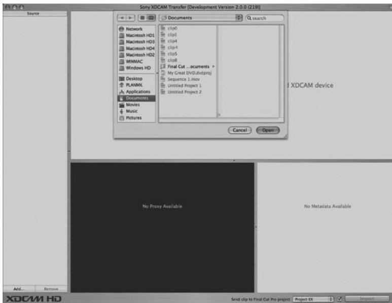
如果SxS PRO存储卡未被自动识别，可点击XDCAM传输窗口左下方的“添加...”键，会出现一个对话框，您可在此选择SxS PRO存储卡。选择列表中的SxS图标，然后单击“打开”，即可显示缩略图。
