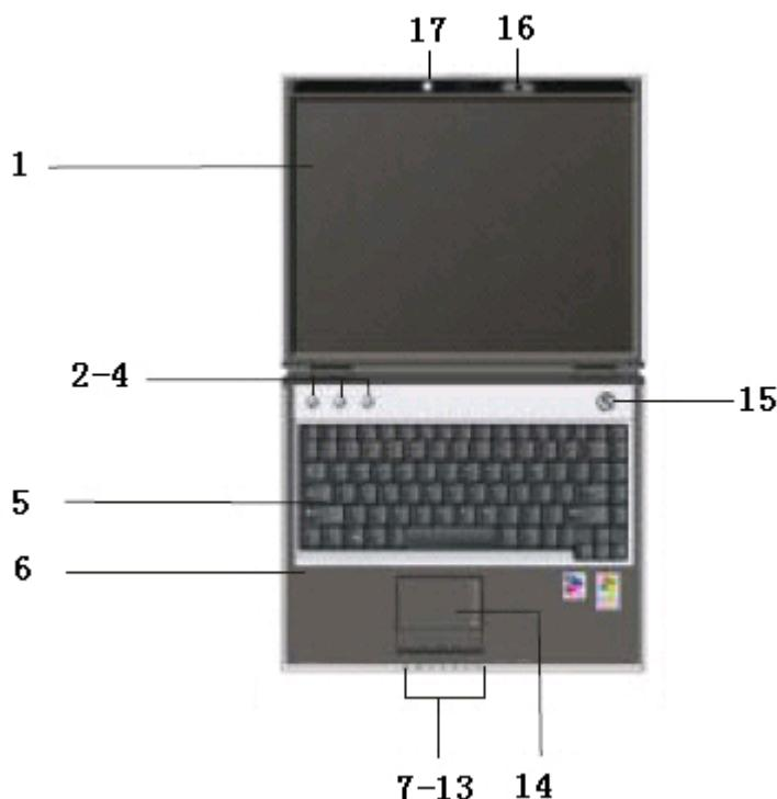
1. **LCD显示面板** 电脑的数据及图形将显示在这个屏幕上。
