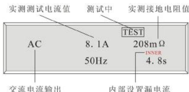
测试过程中，若自动连续测试功能关闭，测试时前面板上的“测试”橙色指示灯点亮。仪表倒计时，如果测试值超过上限预设值或小于下限预设值，测试将立即停止，进入测试完成态给出测试结果；若测试值合格，则进行计时，计时时间到进入测试完成态给出测试结果。
