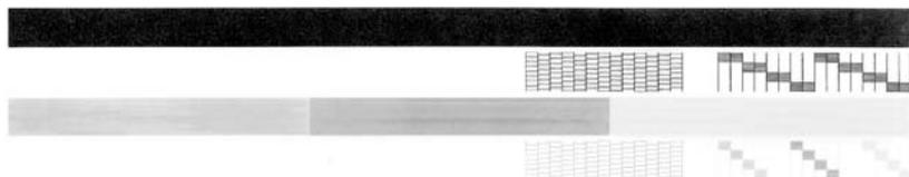
3. 确保测试图案连贯，网格完整。
