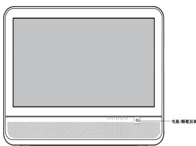
2、按下电源开关,接通主机电源
