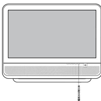
1、按下主机上的显示屏开关按键，这时显示屏的指示灯变亮。
