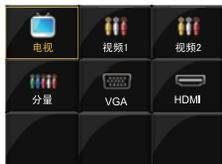
1. 信号源：以菜单方式选择当前输入信号，菜单中提供了该电视机所有信号输入方式，包括：电视、视频1、视频2、分量、VGA、HDMI。
