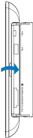
**2** 将存储设备牢固地插入数码相框中。
