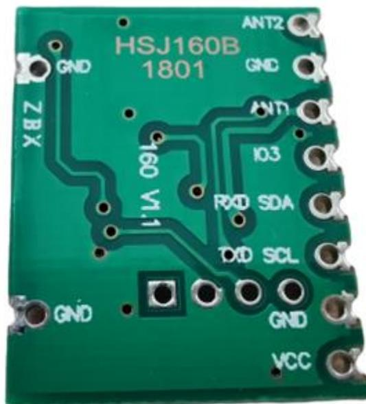
图 1.1 HSJ160B 读卡模块引脚示意图
