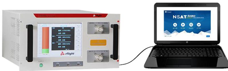
连接线缆电气特性的测试, 量化了射频元件间的传输反射特性, 最大限度地提高功率效率和信号的完整性。是高频产品稳定工作的重要保障。受制于测试手段的影响, 全手工测试只能对各个指标逐一手工测试并记录, 很难保证产品参数测量的一致性和生产的效率。市场竞争和公司综合生产成本的增加, 使自动/半自动化测试已经成为一种趋势。
