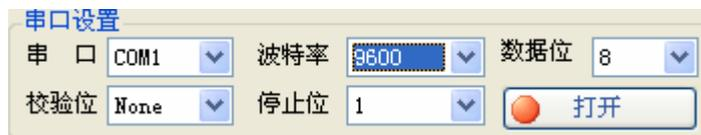
如果上图中串口对应的下拉框为空，则需检查串口线是否与 PC 机正确连接，检查后点击“**打开串口**”重新搜索 COM 串口。
