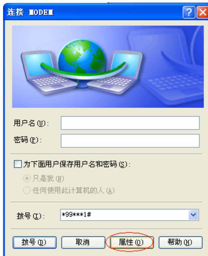
(20)、确认连接时使用标准33600调制解调器，电话号码确认为\*99\*\*\*1#，并点击“配置”；
