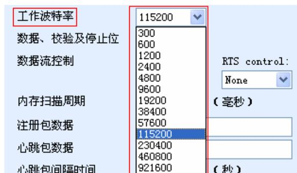
该参数控制 DTU 串口的通信波特率，必须使用标准波特率进行通信。WLDT24DTU 支持的波特率为 300~460800，WLDT26DTU 支持的波特率为 300~921600。
