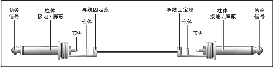
4.2 : 配有 6.3 毫米接插件（非平衡式）的跳接线
