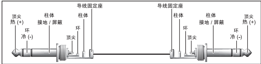
4.3 : 配有 6.3 毫米接插件（平衡式）的跳接线
