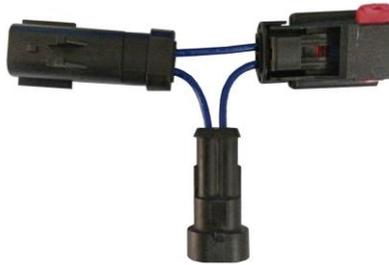
康明斯计量阀电流测量转接线
