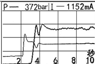
上图为用 RA-3000 轨压和计量阀电流对一台一汽大柴 CA4DC2-10E3 四缸博世共轨柴油机实测的启动过程中的动态波形。这台发动机启动正常。
