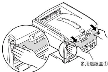
1. 打开多功能纸盒,并轻轻地向下压托纸板①,确保托纸板门锁向下锁住。
