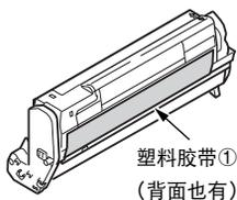
3. 将感光鼓与墨粉盒的连接部分用塑料胶带固定好①，再放回到打印机中。
