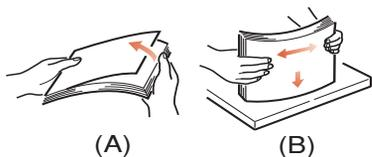
2. 将要装入的纸张边缘呈扇形散开，并使纸张的中间隆起，确保所有纸张都可以完全散开(A)。然后，在平面上垛齐纸张，使纸张重新平整(B)。
