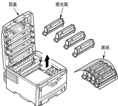
3-4. 重复此拆卸过程，拆下所有这四个感光鼓设备。
