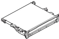
传送带要达到使用期限时在打印机 LCD 屏幕上会显示{ORDER BELT UNIT}的提示信息。如果不更换传送带而继续打印，在出现{REPLACE BELT UNIT}的信息后，会停止打印。
