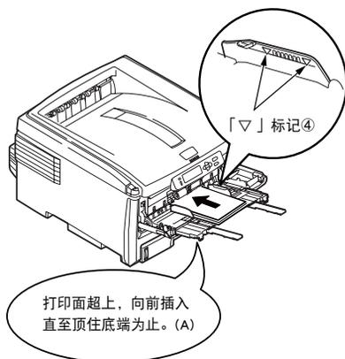
2. 拉出撑纸板②,将纸张的打印面朝上竖直装在多功能纸盒上(A)。然后校准手动导纸器③,使其适合装入纸张的大小。
