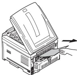
1. 如果纸张的大部分已伸出打印机的顶部，则只需用力抓住纸并轻轻地向外拉，直到将纸张完全拉出。如果纸张不容易拉出，请勿过分用力。稍后可以从后面清除卡纸。
