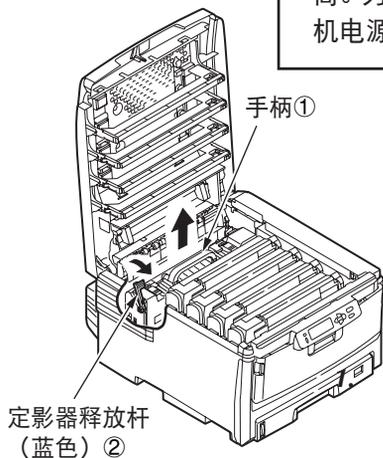
1. 将定影器释放杆(2处)①按箭头方向拉起，使这两个释放杆完全直立。
