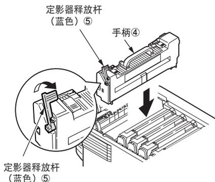
4-4. 向打印机的后面推定影器的两个释放杆 ⑤，直到定影器锁定就位。
