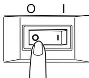
1. 关闭打印机电源（将电源开关置于“O”），拔下电源线、连接缆线，取出纸盒内装入的打印介质。
