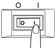
2-1. 打开打印机的电源（将电源开关置于“ I ”）。
