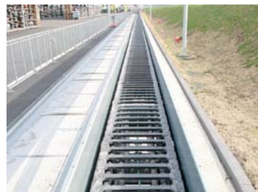
P4.56: 易格斯户外测试装置 - 行程长度为120米
