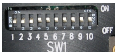
Figure 3-1 (SW1) Commutateur DIP à dix (10) positions
