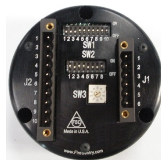
Figure 1-2 Disque du détecteur FS19X/FS20X (vue arrière)
