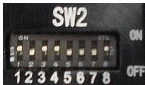
Commutateur DIP à huit (8) positions (SW2) - Figure 3-2
