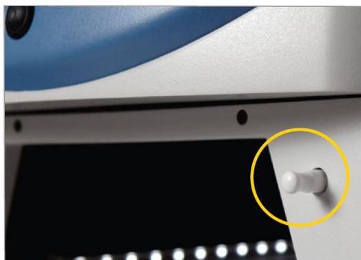
拉伸“UV on（紫外灯开启）”位置 处于拉伸“紫外灯开启”位置中的白色门挂
