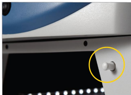
缩回“UV off（紫外灯关闭）”位置 处于缩回“紫外灯关闭”位置的紫外灯白色门挂
