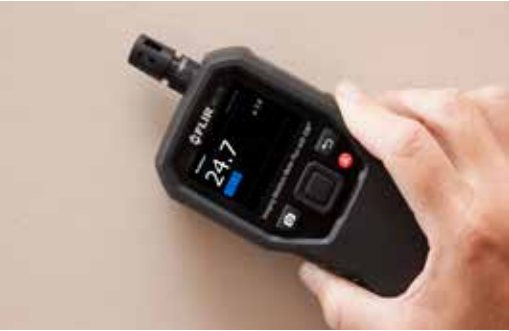
采用无探针测量模式验证湿气问题
