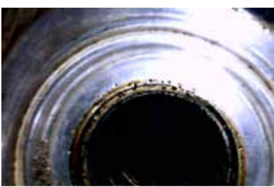
使用6mm长焦镜头 (VSA2-1M-w)检查恒温控制阀
