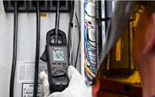
真有效值电流测量值高达600A
