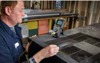
含K型热电偶输入, 适用于温度测量
