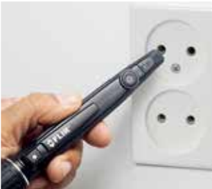
隐蔽式探针在检测安全插座时候十分有用。
