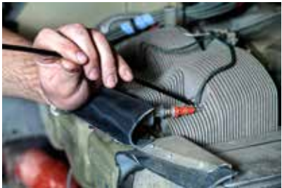
使用VSA2-1M检查飞机引擎汽缸
