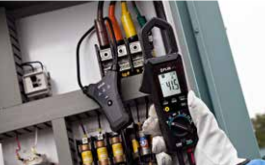
连接TA74柔性电流钳优化测量操作
