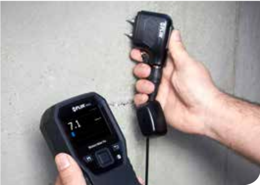
外部探针用于测量电阻材料的湿度
