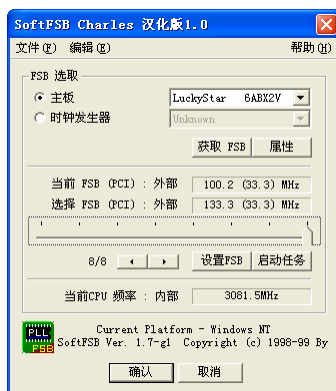
图 18-11 调整前端总线
