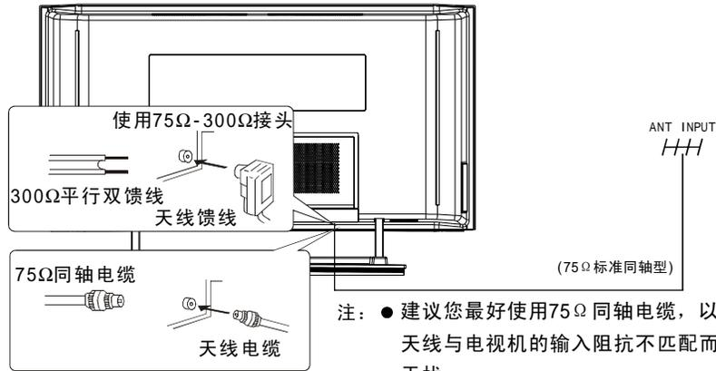
注：● 建议您最好使用 $75\Omega$ 同轴电缆，以消除因天线与电视机的输入阻抗不匹配而导致的干扰。
