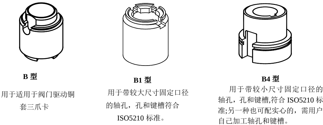
图 6-3 RQIV003~RQIV300、RQMIV03~RQMIV54 执行机构非推力型驱动套示意图
