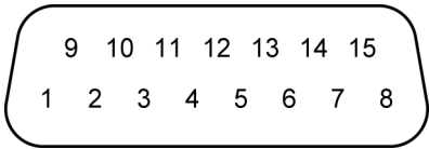
图 6：数据端口管脚布局
