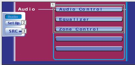
无论在哪个信号源的控制画面，均可以显示相同的音响效果选单。
