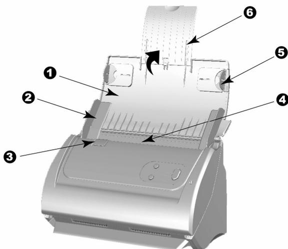
1. 进纸夹—帮助固定纸张位置。在使用扫描仪时，打开进纸夹。
