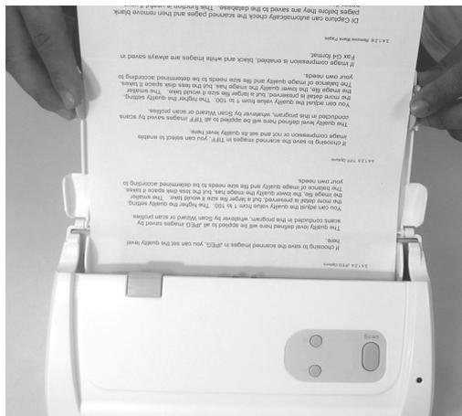
3. 根据纸张宽度调整边夹的宽度。轻推边夹使其正好与纸张接触即可。
