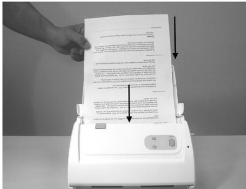
2. 如果您要扫描纸张较长的文件，可以打开纸张延伸板和导纸边夹来固定文稿的位置。
