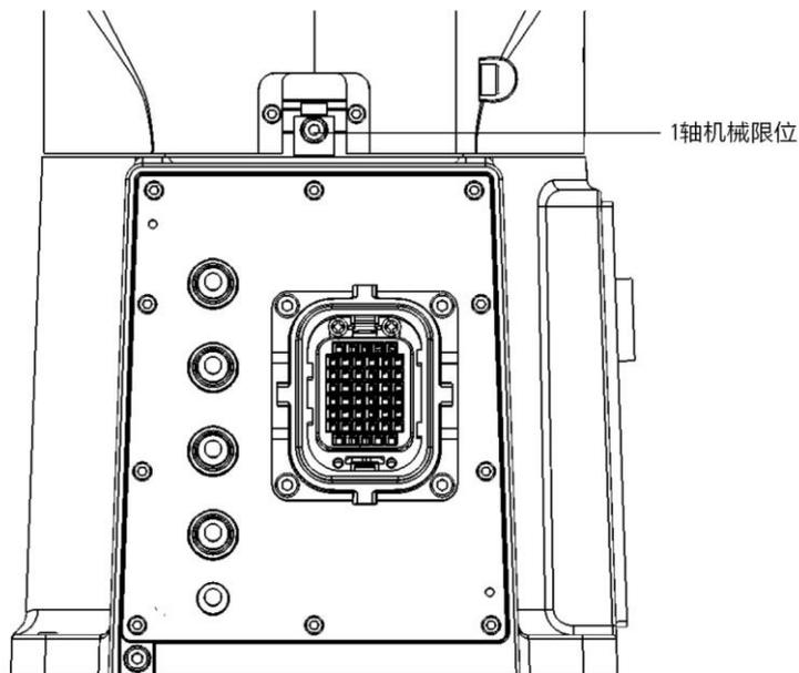
图 6-2AIR3-560A 操作机上机械式制动器
