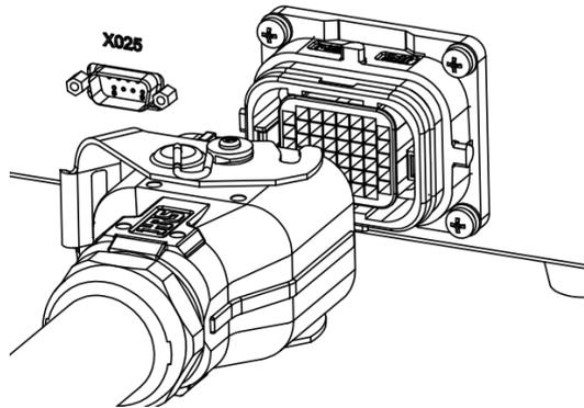
图 5-4 控制柜重载连接器接口
