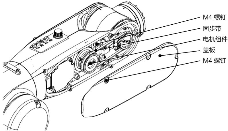
图 10-7 J6 轴同步带更换示意图
