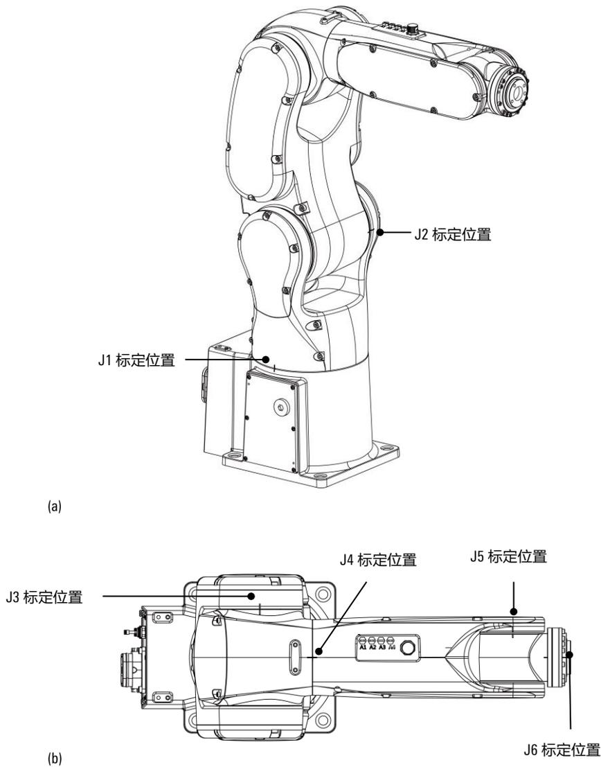
图 6-3AIR3-560A 各轴零点示意图
