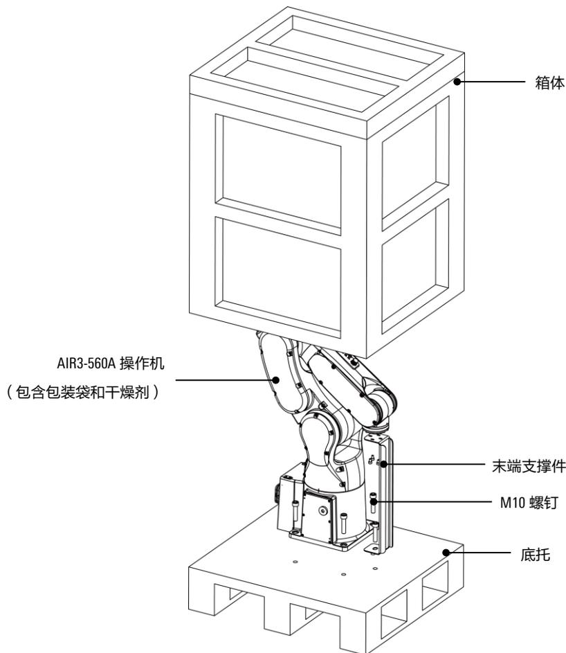
图 3-2AIR3-560A 操作机包装箱的构成
