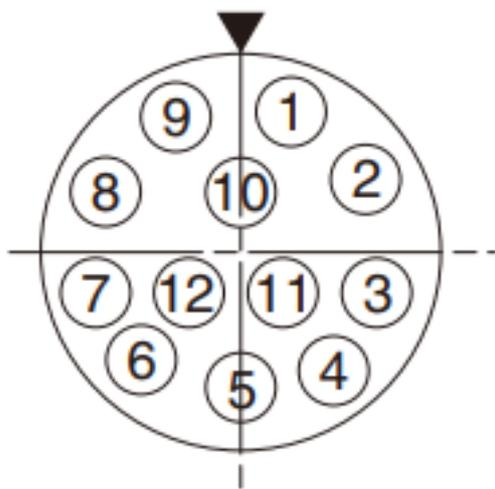
图 4-6 AIR3-560A 型操作机小臂 IO 接口示意图
