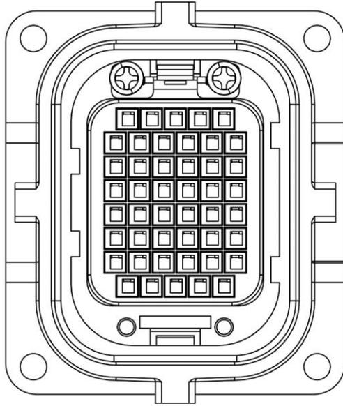
图 4-3 AIR3-560A 型操作机重载接口示意图
