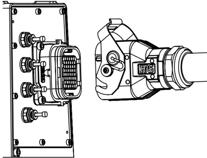
图 5-3 操作机重载线连接接口
