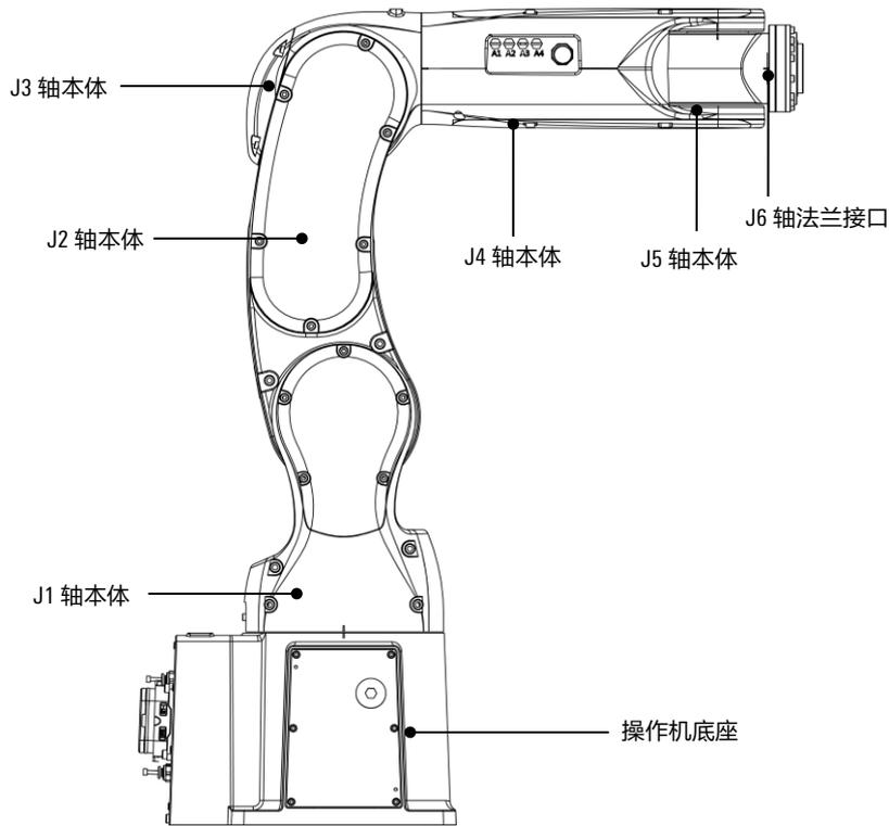
图 2-2AIR3-560A 机器人本体及其各个部分示意图
