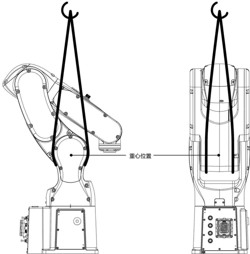
图 7-5AIR3-560A 吊环搬运示意图
