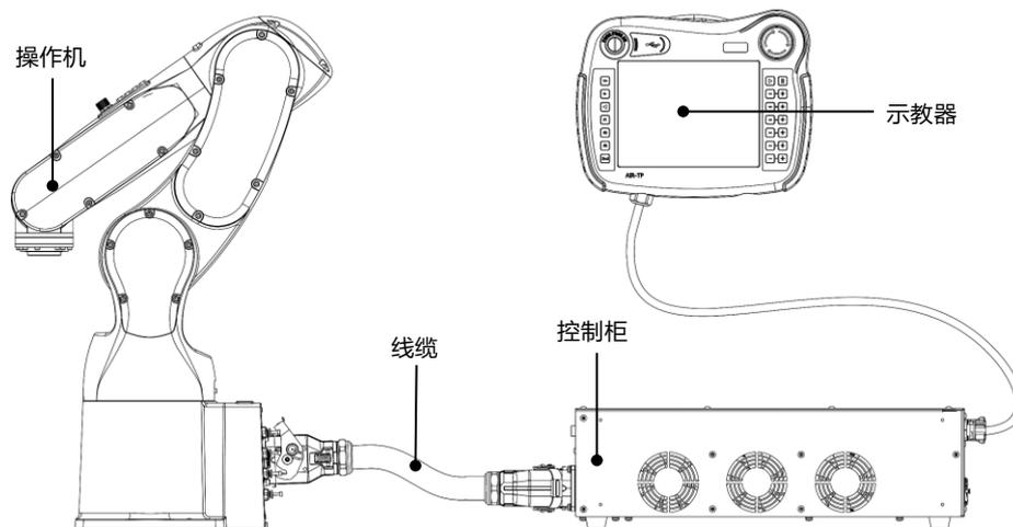
图 2-1 机器人系统的构成
