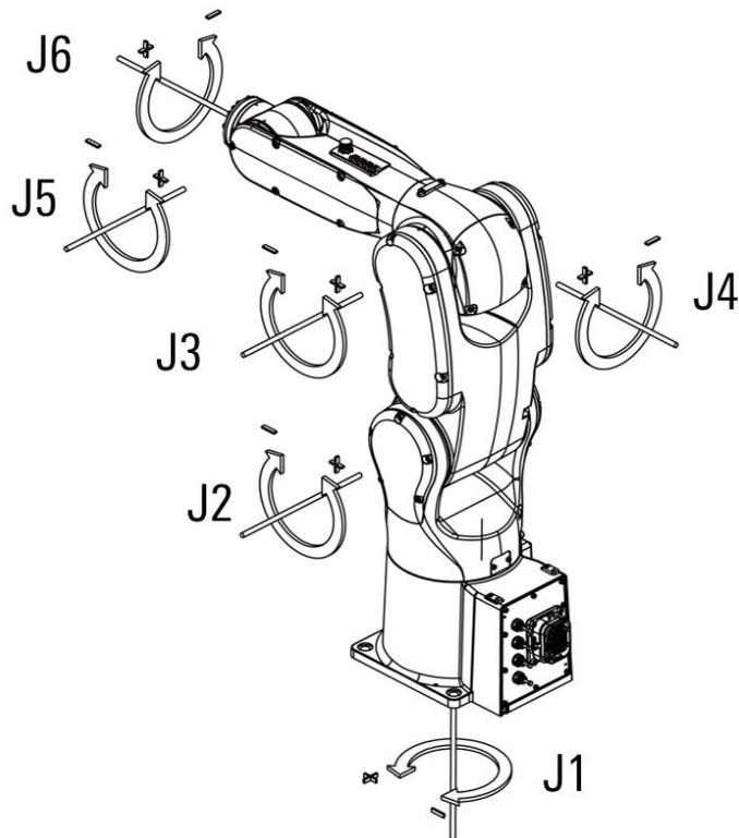
图 6-5 操作机各轴的运动方向
