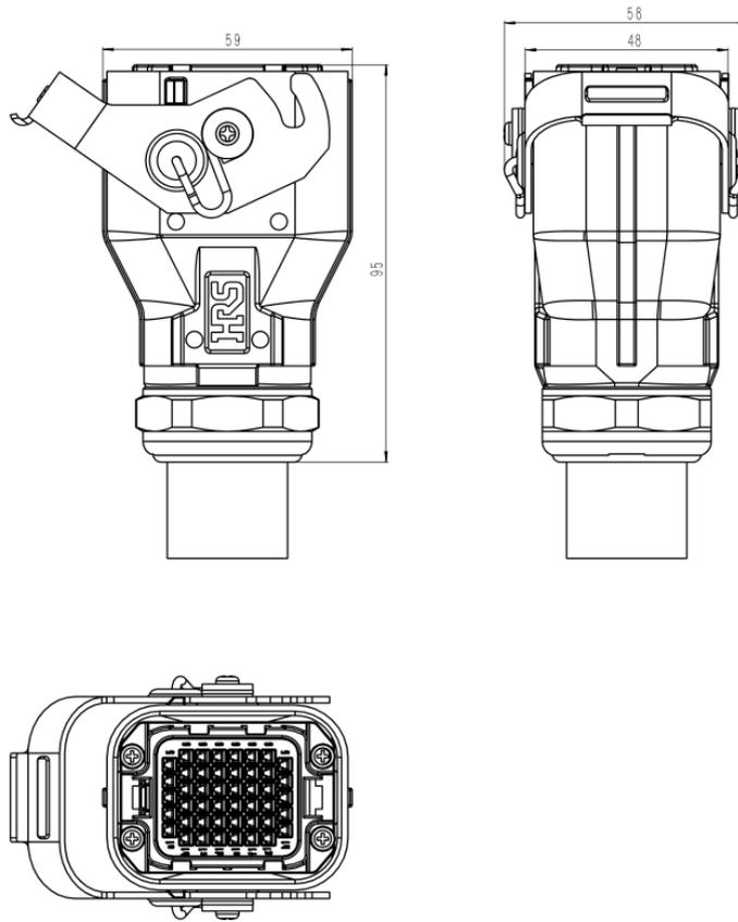
图 4-5 柜体侧重载接头尺寸
