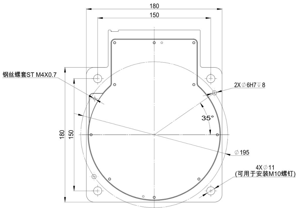
图 3-3AIR3-560A 操作机底座接口尺寸
