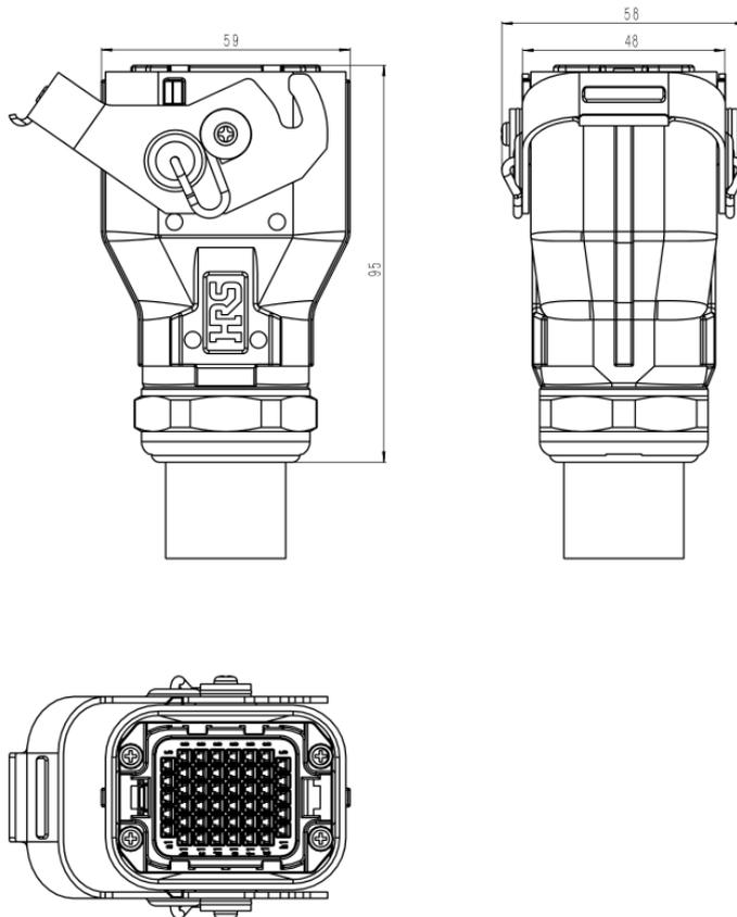
图 4-4 本体侧重载插头尺寸
