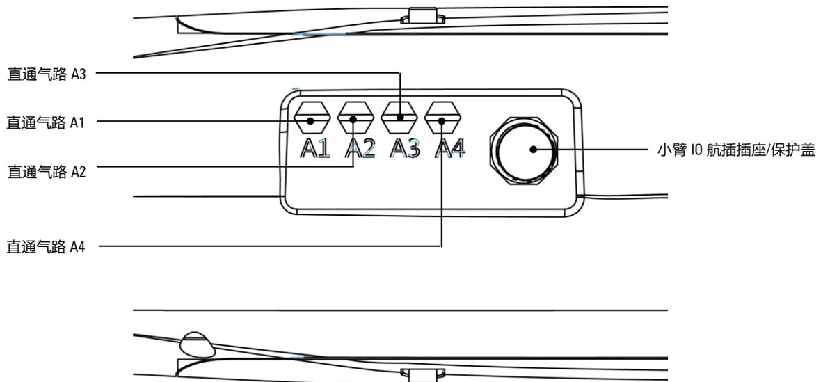
图 4-2AIR3-560A 操作机小臂上接口
