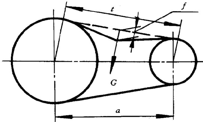
图 10-8 下压力和挠曲量示意图
