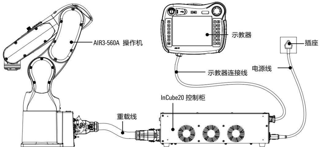
图 5-5 工业机器人系统接线概览
