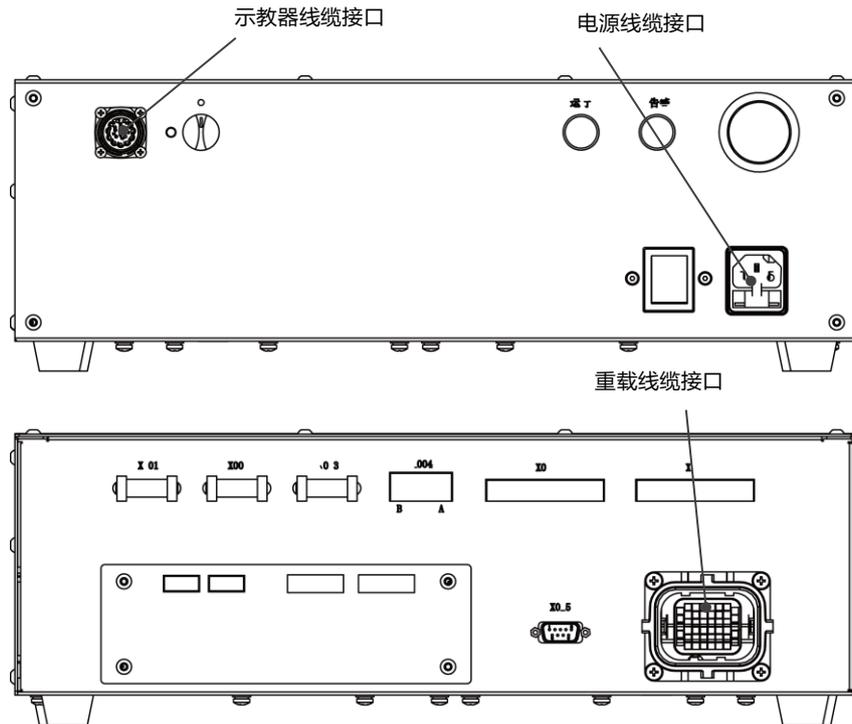
图 5-1AIR3-560A 控制柜线缆连接器定义
