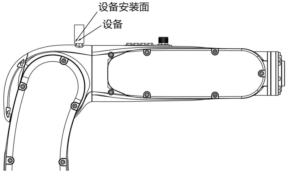
图 6-9AIR3-560A 操作机肘部负载安装尺寸示意图
