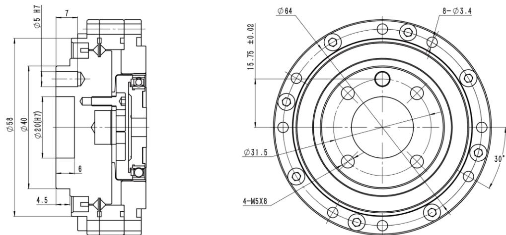
图 6-6AIR3-560A 操作机腕部法兰尺寸示意图
