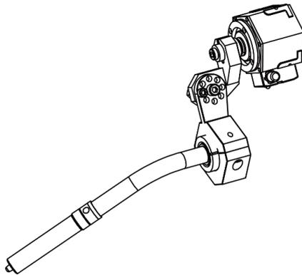
图 5-11 工业机器人用弧焊枪
