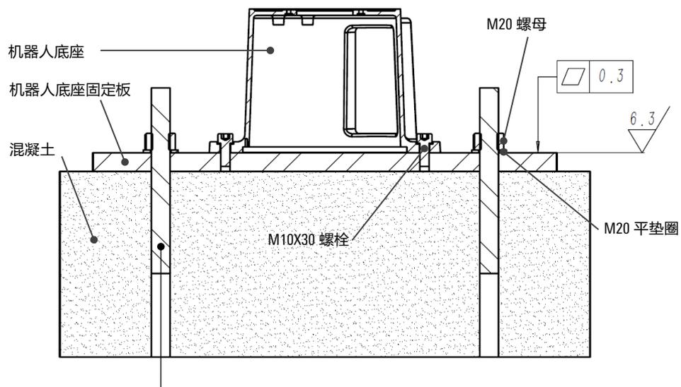
(b) 剖面图 M20 化学螺栓
