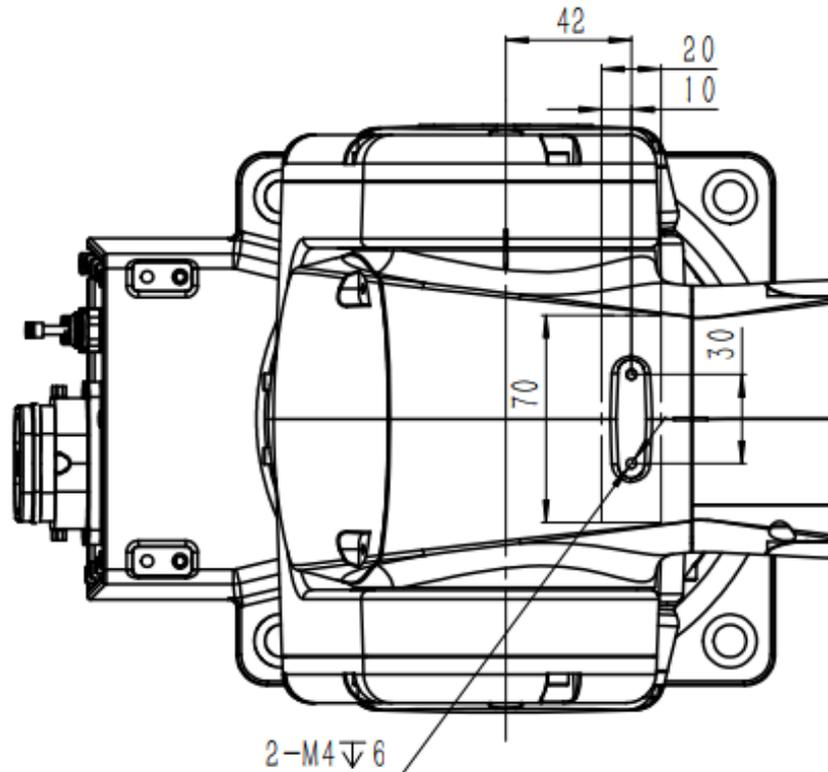
图 6-10AIR3-560A 操作机肘部负载接口尺寸示意图
