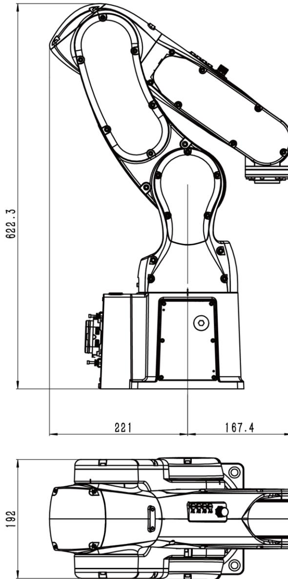
图 7-3AIR3-560A 搬运时操作机尺寸
